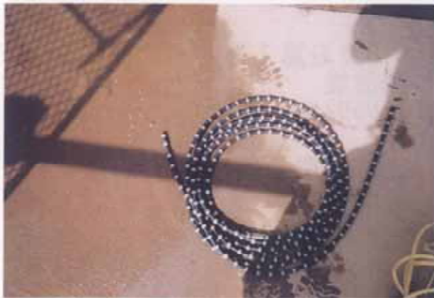
H16災沿第1号 消波堤 ケーソンワイヤーソー切断 ワイヤーソー
